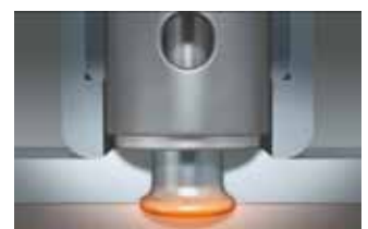
Phase 4: Stauhen und Ausbilden der Verschweißung
