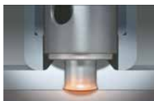
Phase 3: Plastifizieren von Reibelement und Grundblech
