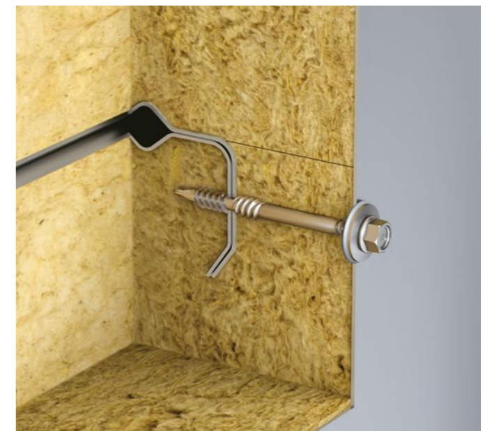
Ohne Vorbohren: Die EJOT Distanzschraube mit Rechts-Links-Rechts-Gewinde verschraubt profilierte Deckelemente und Lisenen (Hutprofile) an überdämmte Kassettenwand-Systeme.
