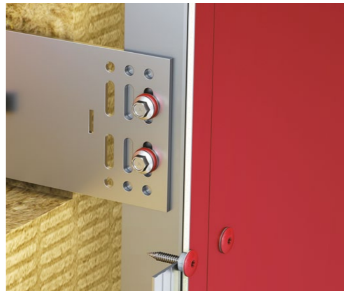
Die EJOT VARIO-Schraube verbindet Wandhalter mit Tragprofilen und gewährleistet ein zwängungsfreies Gleiten der Bauteile.
