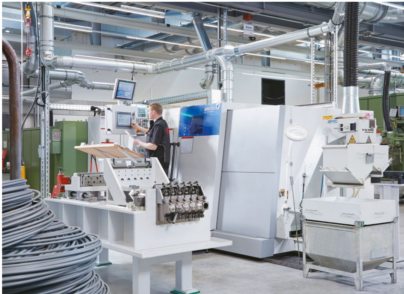
Mitarbeiter beim Einrichten einer 6-stufigen Umformpresse
