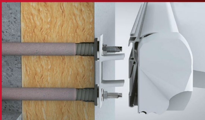
Der EJOT Iso-Bar dient zur nachträglichen Verankerung von Anbauteilen an WDVS-Fassaden.
